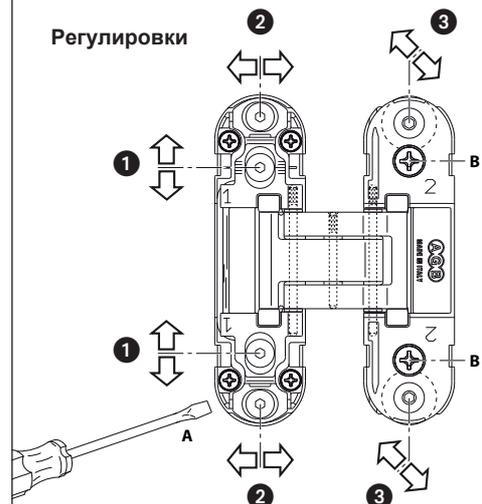
Для регулировки петли используйте шестигранный 3 мм:
